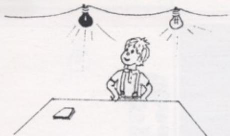
4 - Sopra il piano di lavoro devono essere fissate, alla distanza di circa un metro, la lampada di sicurezza e quella bianca. Questa ti permetterà sia di fornire la luce necessaria all'esposizione della carta sensibile, sia di illuminare il piano per sistemare le cose prima dell'esposizione. Ti sarà utile anche per esaminare il risultato finale dello sviluppo e del fissaggio.
